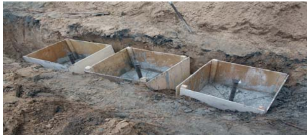
Рисунок 1. Подготовка композиционных имитационных моделей для сравнительной оценки воздействия на образцы пород и ценное кристаллосырьё зарядов ВВ с различной скоростью выделения энергии
